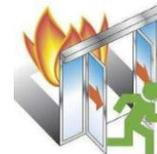
Le **porte di tipo scorrevole** con azionamento automatico sono utilizzabili come uscite di sicurezza, se le stesse possono essere aperte a spinta verso l'esterno.
