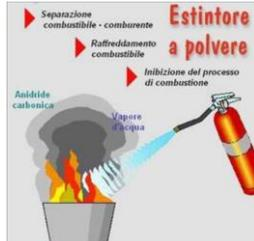
Sono costituite da **particelle solide finissime** a base di bicarbonato di sodio, potassio, fosfati e sali organici.
