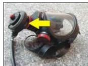
Poi l'aria raggiunge il riduttore del 2° stadio (posto all'interno della maschera facciale in prossimità del sistema erogatore), che permette una seconda riduzione ad una pressione respirabile (**poco più di 1 atm**).
